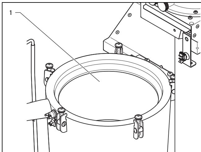
2. Демонтируйте нижнюю часть сифона для конденсата, чтобы не повредить устройство нейтрализации конденсата при его наличии.
