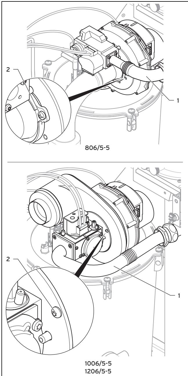
1. Демонтируйте газовую трубу (1) с газовой арматуры.
