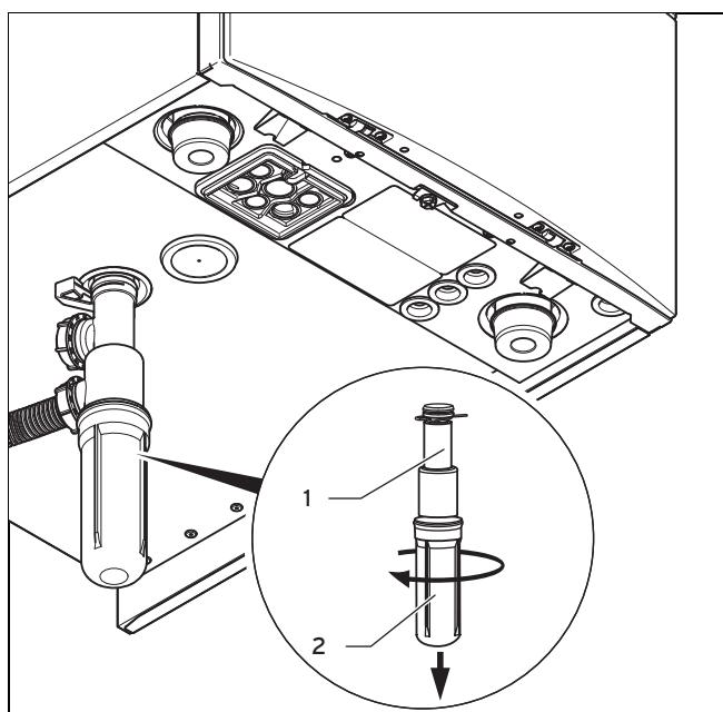
1. Снимите нижнюю часть сифона (2) свинтив ее с сифона конденсата (1).
